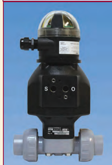
VÁLVULA DE DIAFRAGMA DE TIPO TRUE UNION AIRE-RESORTE DE CPVC DE 2" TIPO 14 CON INTERRUPTOR DE DOBLE LÍMITE NEMA IV
