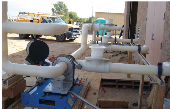
Sistema de distribución de ácido sulfúrico con ECTFE Ultra Proline® de Asahi/America.
